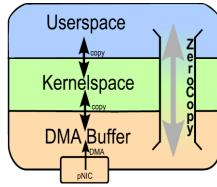
Flaschenhals werden. Dadurch motiviert entstanden sogenannte Zero-Copy Mechanismen. In diesen Mechanismen wird durch Auflösung der Grenzen zwischen Treiber, Betriebssystem und Anwendungen eine höhere Performanz erreicht.
