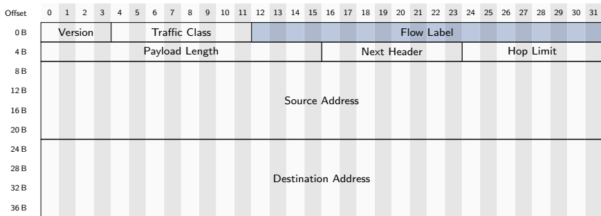
Abbildung: IPv6-Header (minimale Länge: 40 B, vgl. 20 B bei IPv4)
