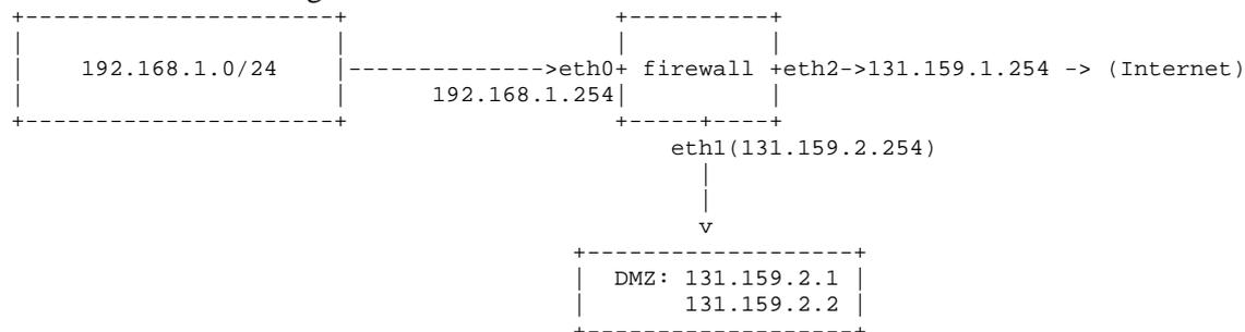
Bei der Firewall handelt es sich um einen PC mit drei Netzwerkkarten und einer Linux-Installation. Dessen netfilter-Paketfilter wurde wie folgt konfiguriert:
