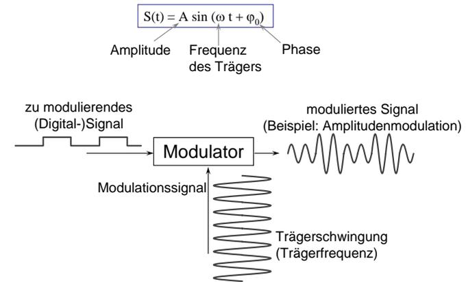
Schwingungsmodulation: analoger Signalträger ist Sinusschwingung
