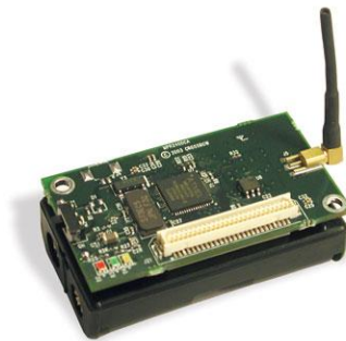
Abbildung 1: Beispiel für Sensorknoten: MICAz von Crossbow Technology [6].
