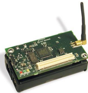
Abbildung 1: Beispiel für Sensorknoten: MICAz von Crossbow Technology [6].
