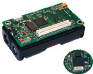
Abbildung 7: Mica-Mote und münzgroße MicaDot-Mote [8]
